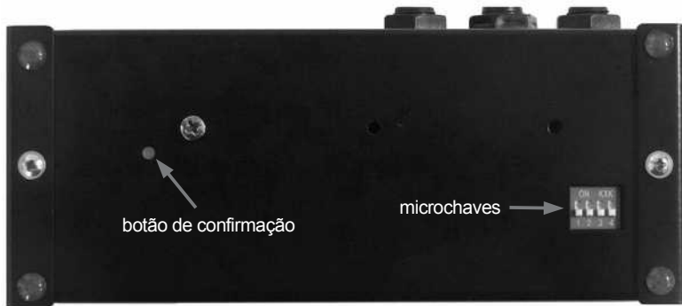
Figura 3: Botão de confirmação e microchaves de configuração na parte inferior do MIDI2CV
