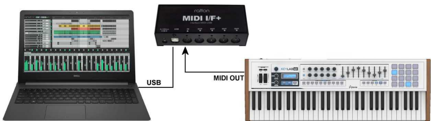
Fig.3 - Exemplo de conexão usando um teclado controlador para transmitir comandos de MIDI para o computador e controlar um instrumento virtual
