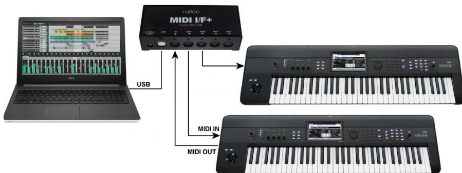
Fig.4 - Exemplo de conexão em que um teclado transmite comandos de MIDI para o software no computador, e para que o software também envie comandos de MIDI para todos os instrumentos
