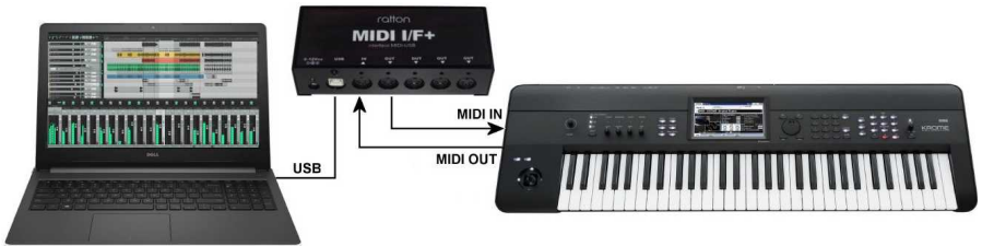
Fig.2 - Exemplo de conexão usando um teclado sintetizador para transmitir comandos de MIDI para o computador e receber comandos de MIDI do computador
