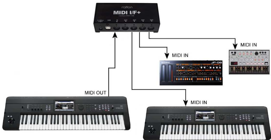
Fig.5 - Exemplo em que a MIDI I/F+ opera como distribuidor de dados de MIDI ("MIDI thru box"). Neste caso, o teclado da esquerda transmite comandos de MIDI para os demais equipamentos
